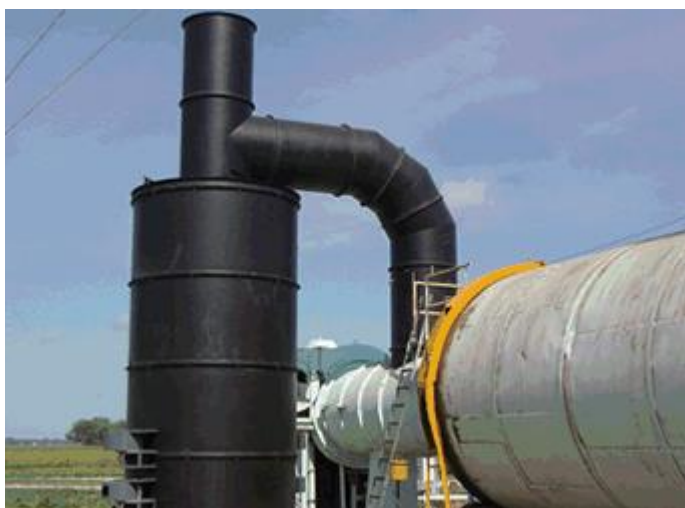
Figuur 2 Voorbeelden van een tweekamer cycloonoven (Andritz Eco-dry) en een éénkamer cycloonoven (ONIX) bij een droogtrommel voor hout
